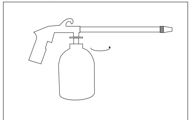
En la entrada del aire de la pistola recomendamos colocar un conector de acoplamiento rápido para hacerlo más práctico.
